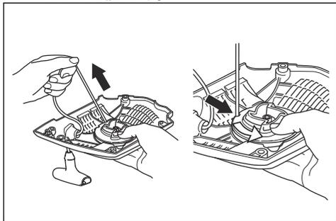
5. 中央のネジ、ドライブディスク (A)、ドライブディスクスプリング (B)、プーリー (C) を取り外します。
