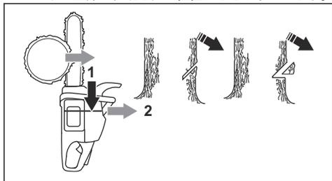
2. 受け口下部が水平で、倒す方向に対して 90° であることを確認します。
