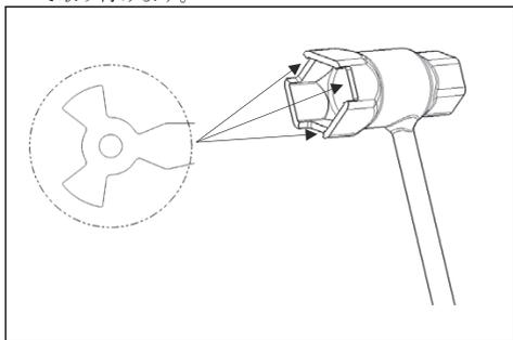
2. ブレーキを取り付け直すには、リンクを時計方向に止まるまで回します。チェンブレーキのロックが解除されているとき、前側リンクは回転位置の下側にきます。
