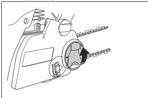
2. ノブを反時計方向に回してクラッチカバーを緩めます。
