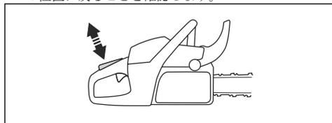
3. スロットトリガーロックを放したとき、スロットトリガーがアイドリングの位置にロックされていることを確認します。
