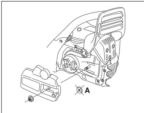
**注記：** クラッチカバーが取り外しにくい場合は、バーナットを締め込んで、チェンブレーキをかけて解除します。正しく解除された場合は、カチッという音がします。
