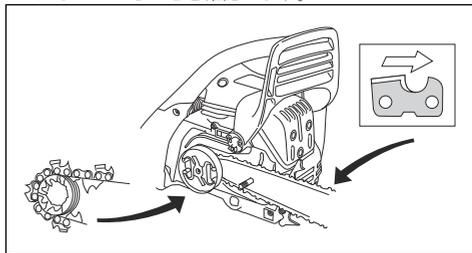
6. ガイドバーの穴をチェーン調整ピンに合わせて、クラッチカバーを取り付けます。
