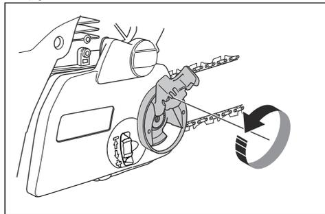
3. チェンテンションホイールを下に回して (+)、ソーチェンを張ります。チェンテンションホイールを上回して (-)、ソーチェンの張りを緩めます。
