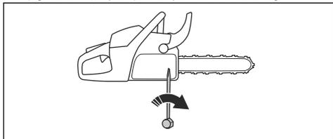
5. レンチを使用してバーナットを締め込みながらガイドバーの前方を持ち上げます。
