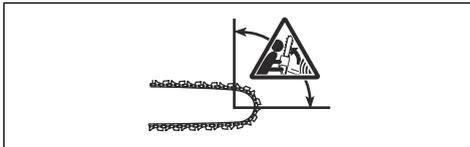
キックバックは、常にガイドバーの切創面に起こります。通常、本体は作業者に向かって跳ね返りますが、別の方向に向かう場合もあります。キックバック発生時に本製品をどのように使用していたかによって、キックバックの動きの方向が決まります。
