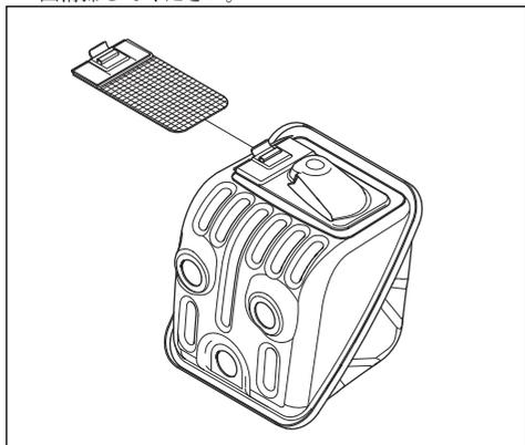
4. 損傷したスパーク防止ネットは交換してください。
