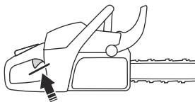
4. Paleiskite gaminį ir stipriai spustelkite akceleratorių.
