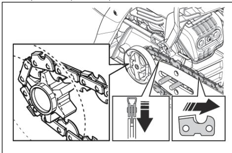
5. Убедитесь, что кромки режущих звеньев направлены вперед на верхней стороне направляющей шины.
