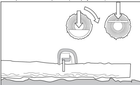
• Если бревно установлено на опору с одной стороны, выполните рез на 1/3 диаметра, начиная с нижней части бревна ("снизу вверх").
