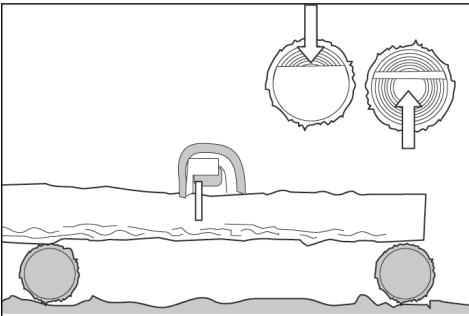
• При распиловке бревна на склоне всегда стойте с верхней стороны бревна. Разрежьте бревно, полностью контролируя изделие. Затем снизьте давление резки ближе к концу реза, не отпуская заднюю и переднюю рукоятки.
