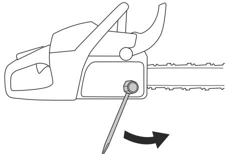
2. Затяните гайки крепления направляющей шины от руки с максимально возможным усилием.
