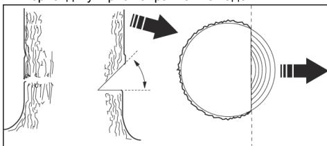
3. Выполните нижний горизонтальный рез подпила. Это позволит избежать защемления цепи пилы или направляющей шины при выполнении второго подпила.
