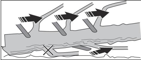
3. Обрезайте ветки, находящиеся в напряжении, снизу вверх, чтобы избежать защемления цепи пилы или направляющей шины.
