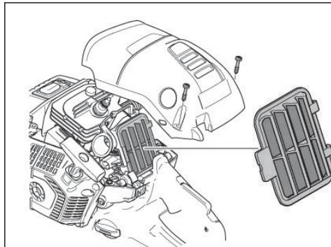
2. Промойте воздушный фильтр теплой мыльной водой. Перед установкой фильтра на место убедитесь, что он полностью высох.
