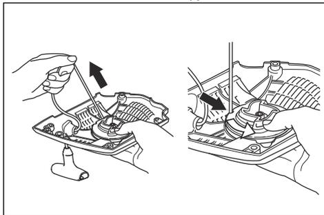
5. Премахнете централния винт, задвижващия диск (A), пружината на задвижващия диск (B) и ролката (C).
