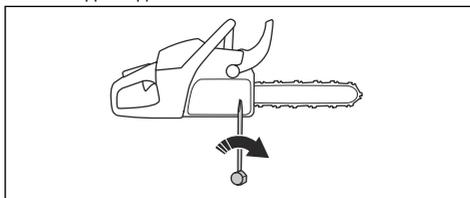
5. Затегнете гайките на шината с гаечния ключ и същевременно повдигнете предната част на направляващата шина.
