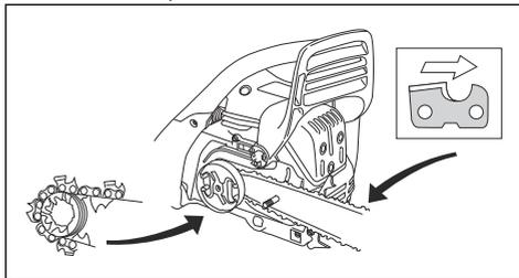
6. Подравнете отвора в направляващата шина с регулиращия щифт на веригата и монтирайте капака на съединителя.
