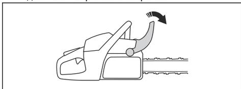
2. Издърпайте превключвателя за включване/изключване (A) навън и нагоре, за да го поставите в положение „задействан смучач“.
