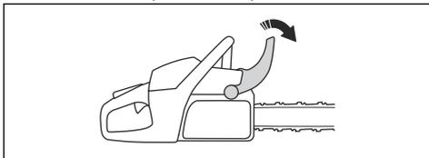
2. Издърпайте превключвателя за включване/изключване (A) навън и нагоре, за да го поставите в положение „задействан смукач“.
