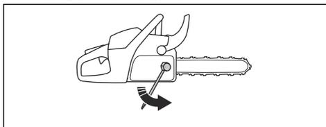
**Забележка:** Някои модели имат само една гайка на шината.
