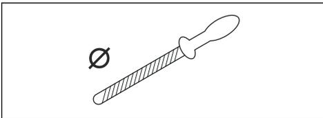
Ohne Hilfsmittel ist es nicht leicht, eine Sägekette korrekt zu schärfen. Verwenden Sie die empfohlene Schärfelehre. Dies hilft Ihnen, die maximale Schneidleistung zu erhalten und die Rückschlaggefahr auf ein Minimum zu reduzieren.
