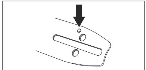
2. Kontrollieren Sie, ob die Ölzuführung im Getriebegehäuse verstopft ist. Reinigen Sie sie bei Bedarf.
