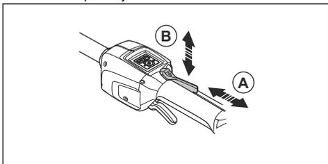
3. Sprožilnik plina in zaklep sprožilnika plina se morata prosto premikati in povratni vzmeti morata delovati pravilno.
