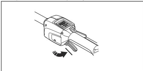
2. Zaklep sprožilnika plina pritisnite naprej (A) in navzdol. Zaklep sprožilnika plina pritisnite ob ročaj (B) in se prepričajte, da se nato ob sprostitvi vrne v izhodiščni položaj.
