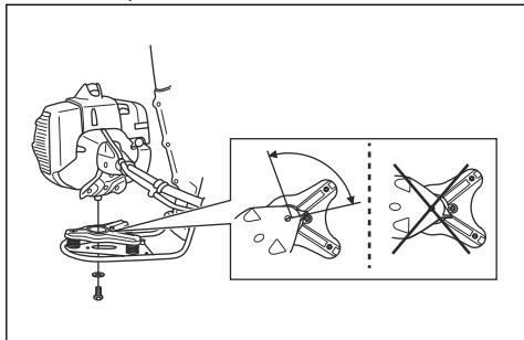
2. Serrez l'écrou avec la clé mixte à un couple d'environ 15 Nm.
