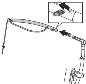
2. Bringen Sie den oberen Teil (B) des Lastreduzierers am unteren Teil (A) des Lastreduzierers an.
