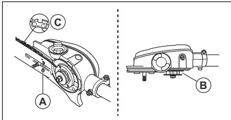
5. Span de ketting door met behulp van de combiseutel de kettingspanschroef met de klok mee te schroeven. De ketting moet aangespannen worden tot ze niet langer slap hangt aan de onderkant van het zaagblad.
