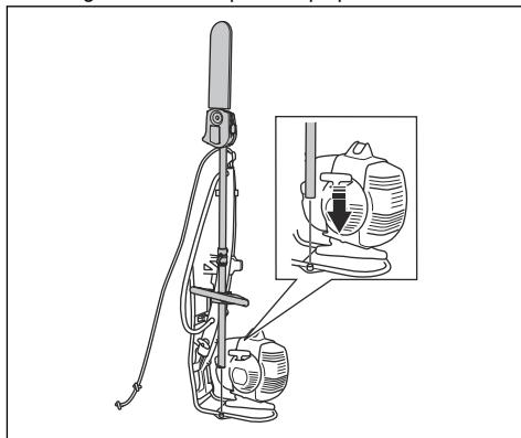
8. Wickel het snoer rond de belastingverlager en de steel. Bevestig het snoer aan de steel.
