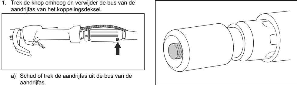
5. Draai en druk tegelijkertijd op de aandrijfas om deze te bevestigen.
