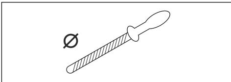
Het is niet gemakkelijk om zonder de juiste hulpmiddelen een zaagketting correct te slijpen. Gebruik een Husqvarna-vijlmal. Hiermee zorgt u voor maximale zaagprestaties en beperkt u het risico op terugslag.
