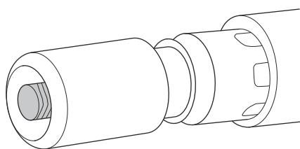
5. Drücken und drehen Sie die Antriebswelle gleichzeitig, um sie zu verbinden.
