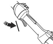
3. Drücken Sie die Gashebelsperre, und kontrollieren Sie, ob sie beim Loslassen in die Ausgangsstellung zurückkehrt.
