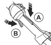
2. Lösen Sie die Gashebelsperre, und stellen Sie sicher, dass der Gashebel in der Leerlaufstellung verriegelt ist.
