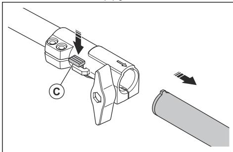
5. Halten Sie das Ende des Führungsrohrs fest, das am Motor befestigt ist.
