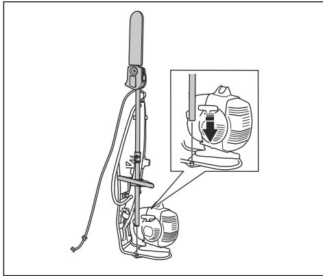
8. Wickeln Sie den Faden um den Lastreduzierer und das Führungsrohr. Befestigen Sie den Faden am Führungsrohr.
