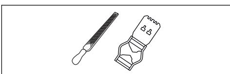
1. Gebruik een platte vijl en een vijlmal om de hoogte van de dieptesteller aan te passen. Gebruik alleen een Husqvarna-vijlmal om de juiste tanddiepte en vijlhoek te verkrijgen.
