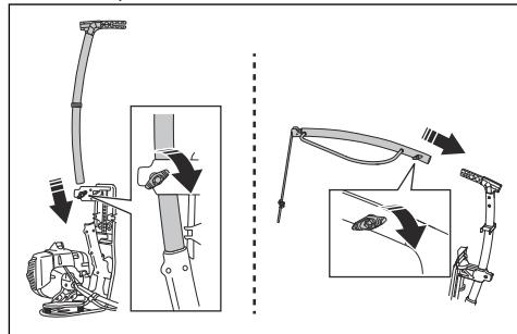
3. Montieren Sie den oberen Teil des Lastreduzierers. Ziehen Sie den Drehknopf an.
