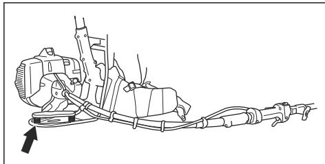
3. Zorg ervoor dat de elementen van de trillingsdempingssystemen correct zijn bevestigd.
