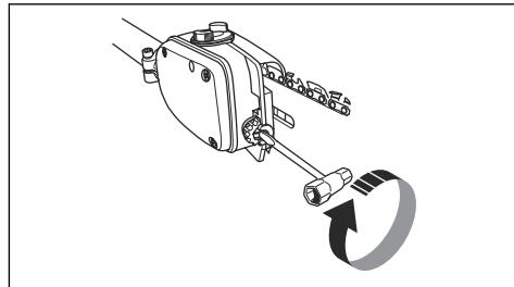
6. De ketting is juist gespannen wanneer ze niet langer slap hangt aan de onderkant van het zaagblad en toch gemakkelijk met de hand kan worden voortbewogen. Hou de tip van het blad omhoog en draai de zaagbladmoeier met de combiseutel vast.
