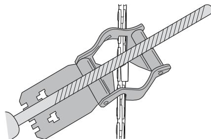
4. Entfernen Sie Material von der einen Seite aller Schneidezähne.
