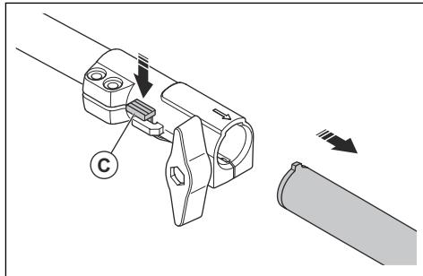
5. Houd deze stevig vast aan het uiteinde van de steel waarop de motor is bevestigd.
