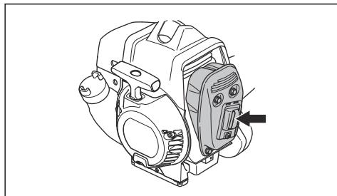
3. Wenn Ihr Gerät über einen speziellen Funkenschutz verfügt, reinigen Sie diesen einmal pro Woche.
