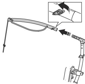
2. Fixez la partie supérieure (B) du réducteur de charge sur la partie inférieure (A).
