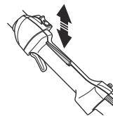
4. Prüfen Sie, ob sich der Gashebel und die Gashebelsperre frei bewegen lassen und ob die Rückholfedern korrekt funktionieren.
