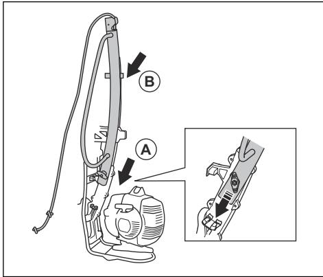
3. Drehen Sie den Knopf 3 Umdrehungen oder mehr, um die Kupplung am Führungsrohr zu lösen.
