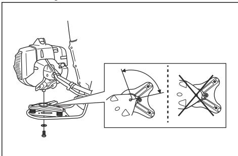
2. Ziehen Sie die Mutter mit einem Kombischlüssel und einem Anzugsmoment von etwa 15 Nm an.
