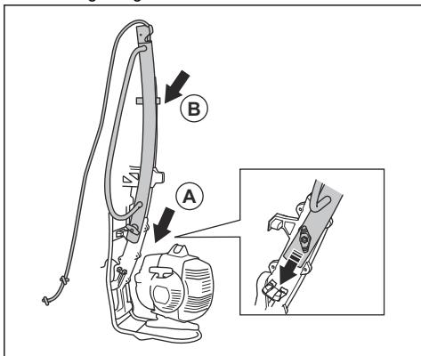
3. Draai de knop 3 slagen of meer om de koppeling op de steel los te maken.
