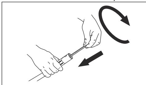
4. Lijn het gat in de bus van de aandrijfas uit met de knop op het koppelingsdeksel.
