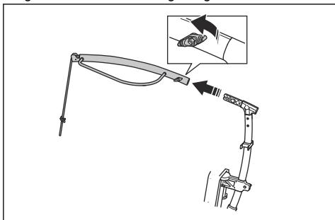
2. Bevestig het bovenste deel (B) van de belastingverlager aan het onderste deel (A) van de belastingverlager.
