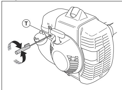
4. Drehen Sie die Leerlaufstellschraube gegen den Uhrzeigersinn, bis die Sägekette stehen bleibt.
