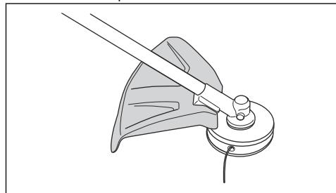
Vérifiez si la protection de l'accessoire de coupe présente des dommages ou des fissures. Remplacez-la si elle présente des dommages ou des fissures. Utilisez uniquement la protection homologuée pour l'équipement de coupe.
