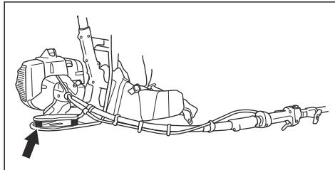
3. Assurez-vous que les éléments des systèmes anti-vibrations sont correctement fixés.
