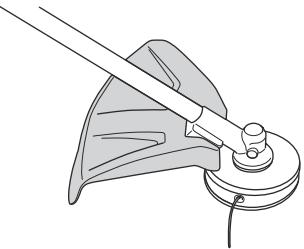
Controleer de beschermkap van de snijuitrusting op beschadigingen en scheuren. Vervang als deze is beschadigd of scheuren vertoont. Gebruik alleen de goedgekeurde beschermkap voor de snijuitrusting.
