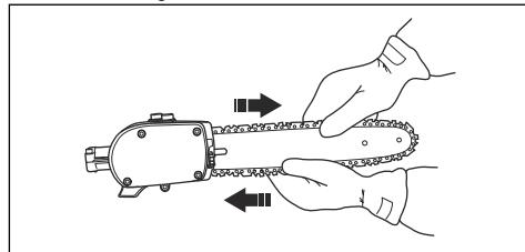
7. Op een nieuwe ketting moet de kettingspanning vaak gecontroleerd worden tot de ketting goed "ingelopen" is. Controleer de kettingspanning regelmatig. Correct aangespannen kettingen geven goede bedrijfsprestaties en hebben een lange levensduur.
