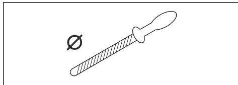
Het is niet gemakkelijk om zonder de juiste hulpmiddelen een zaagketting correct te slijpen. Gebruik een Husqvarna-vijlmal. Dit helpt u om de maximale snijprestaties te behouden.
