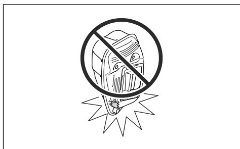
De geluiddemper is bedoeld om geluidsniveaus zo laag mogelijk te houden en om de uitaatgassen weg te voeren van de gebruiker. Voor geluiddempers is het erg
