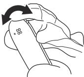
7. Draai de geleider dagelijks om de levensduur te verlengen.
