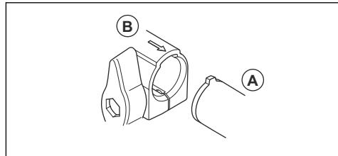
3. Drücken Sie das Führungsrohr vorsichtig in die Verbindung, bis Sie ein „Klicken“ hören.
