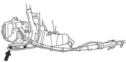
3. Stellen Sie sicher, dass die einzelnen Teile des Antivibrationssystems ordnungsgemäß befestigt sind.
