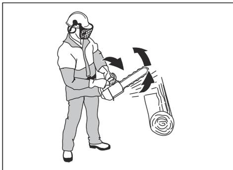
Un piccolo raggio sulla punta della barra diminuisce la forza del contraccolpo.
