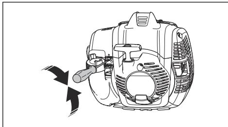
4. Затем поворачивайте винт регулировки против часовой стрелки, пока режущий блок не остановится.
