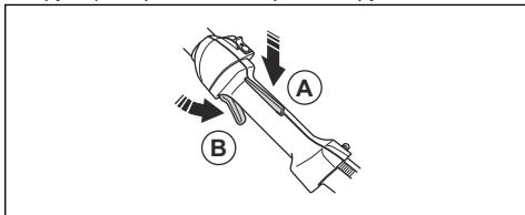
2. Убедитесь, что при отпускании стопора дроссельный регулятор блокируется в положении холостого хода.
