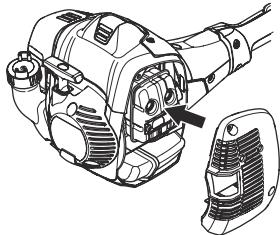
3. Отверните винт, фиксирующий искрогасительную сетку.
