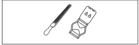
1. Χρησιμοποιήστε μια επίπεδη λίμα και ένα όργανο μέτρησης βάθους για να προσαρμόσετε τη ρύθμιση του μετρητή βάθους. Χρησιμοποιήστε μόνο το όργανο μέτρησης βάθους της Husqvarna για να επιτύχετε τη σωστή ρύθμιση του μετρητή βάθους και τη σωστή γωνία για το μετρητή βάθους.
