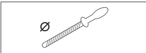
Δεν είναι εύκολο να ακονίσετε μια αλυσίδα πριονιού σωστά χωρίς το σωστό εξοπλισμό. Χρησιμοποιήστε οδηγό ακονίσματος της Husqvarna. Αυτό θα σας βοηθήσει να διατηρήσετε τη μέγιστη απόδοση κοπής.
