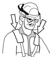
5. Nastavte si správnu polohu popruhov tak, aby bol rezací nadstavec rovnobežne so zemou.
