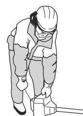
5. Pomalu vytáhněte rukojet startovací šňůry, než učítíte odpor, a poté silou zatáhněte za rukojet startovací šňůry.
